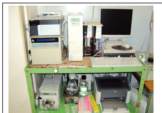
単糖分析専用に使っている HPLC 装置。 高温対応のカラムオーブンが必要。 溶離液の塩濃度が高いので、小まめなメン テナンスが必須。
